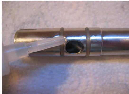
Retirons à présent le cocking-rod, cette fameuse pièce qui permet de tirer le marteau en arrière dans la phase de réarmement du lanceur. Il suffit de le dévisser et de le tirer en arrière.
