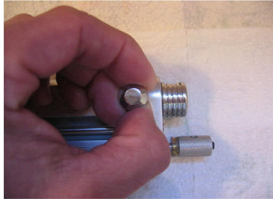
Ceci fait, retirer la culasse du corps de l'autococker en la tirant en arrière.
