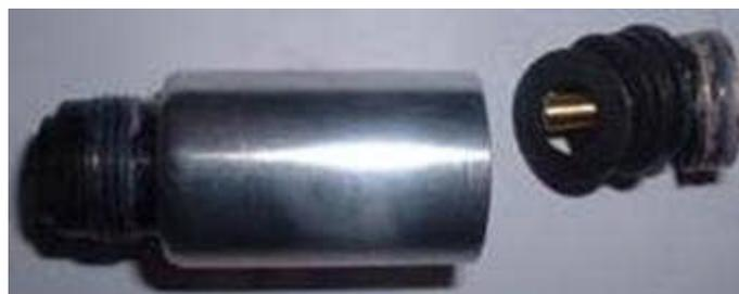
Dégager les rondelles, le joint du piston et tout nettoyer (nettoyer aussi l'intérieur de l'in line).
