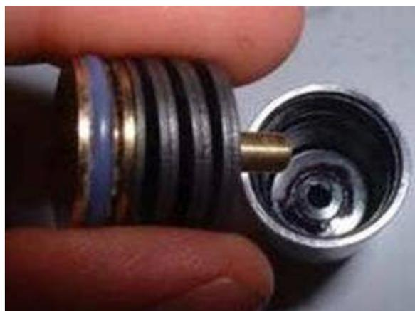
Remonter le joint sur la tête de l'inline (graisser le légèrement) et le revisser sur le corps.
