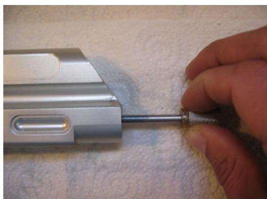
Tirons maintenant le marteau en arrière jusqu'à apercevoir le contre écrou du marteau à travers le trou situé du côté gauche de votre lanceur (indiqué par la flèche rouge sur la photo). Dévissons ensuite le contre écrou en utilisant soit un petit tournevis plat, soit une clé Allen 2,5 de taille française (marteau Belles) selon les cas.
