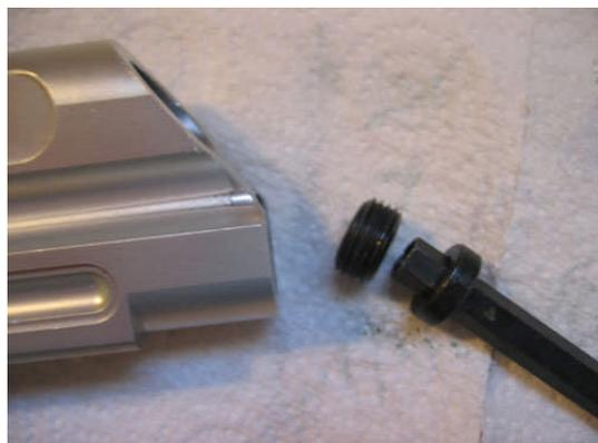
Nous devons maintenant retirer le deuxième contre écrou, celui qui empêche le guide de valve de pivoter à l'intérieur du corps. Si c'était le cas, l'air ne pourrait plus arriver jusqu'à la culasse, puisque la « sortie » serait bouchée !!! Utilisons cette fois la clé Allen 5/32 pour procéder à l'opération.
