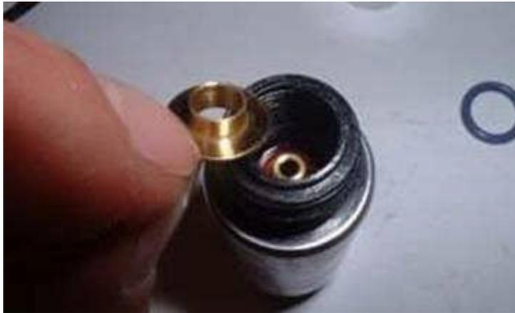
Remonter le petit ressort et la vis de réglage en mettant le côté avec la rondelle en plastique coté ressort (coté intérieur).
