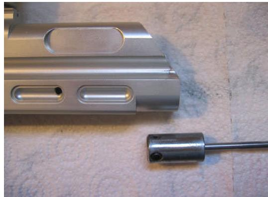
Le marteau a lui aussi besoin d'être lubrifié. Avant de le remonter nous étalerons une légère couche de graisse Dow 33 sur toute sa surface. Ceci participera à faciliter le travail du RAM lors de la phase de rechargement du lanceur.
