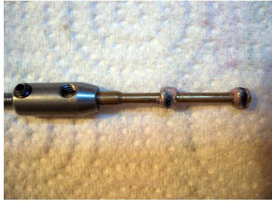
Avec les doigts, étalons la graisse sur les deux joints de façon régulière et mettons la pièce de côté jusqu'au remontage.
