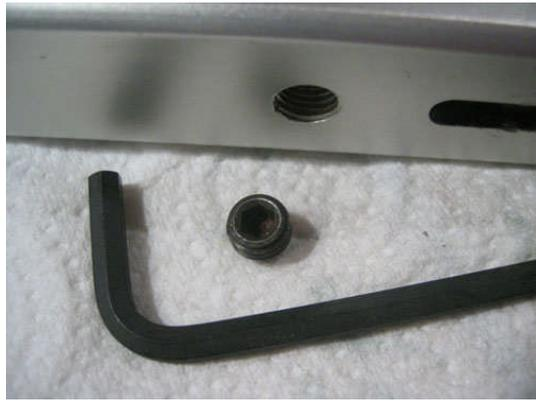
Nous pouvons maintenant retirer la valve. Il va falloir d'abord la déloger à l'aide d'une petite clé Allen (peu importe la taille cette fois-ci) car pour l'instant, son joint la maintient en place à l'intérieur du corps. A l'aide de cette clé, poussons la valve vers l'arrière du lanceur et une fois délogée, utilisons l'outil de valve pour la retirer du corps.
