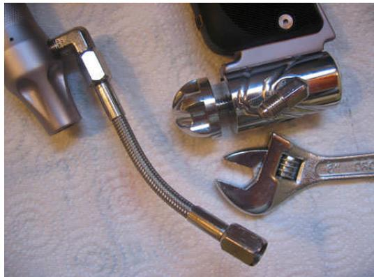
b) Séparons maintenant le Craddle de la poignée en dévissant les écrous de fixation. Encore une fois nous utiliserons la clé Allen 1/8.
