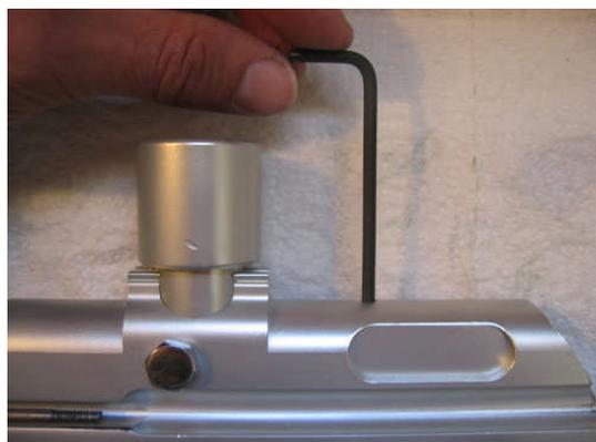
Revissons le contre écrou situé sur le côté gauche du lanceur. Nous pouvons à présent tirer le cocking-rod en arrière pour libérer le marteau. **Si ça force, il ne faut pas insister, mais répéter l'opération, l'accroche de marteau n'est peut-être pas assez (ou peut-être trop) dévissée.**
